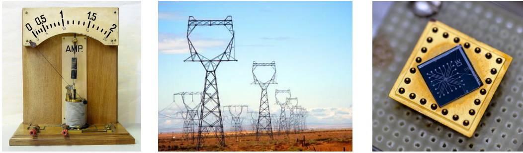
Figura 1.8: (a) Amperímetro histórico (moving-vane, siglo XX): medía corriente por desviación mecánica de aguja. Funcional pero sin definición rigurosa. (b) Líneas de transmisión (powerlines): contexto cotidiano. La corriente eléctrica que corre por ellas depende de que 1 amperio sea preciso y universal. (c) Chip cuántico moderno: representa medición de carga elemental. La nueva definición no es mecánica — es cuántica. — Evolución de la corriente: de aguja mecánica a conteo de electrones.
