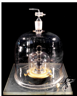
Figura 1.3: (a) Prototipo Internacional del Kilogramo (Sèvres, Francia): cilindro de platino-iridio que definía la masa durante 130 años. (b) Gráfico de derivación relativa de masa de prototipos nacionales (1889–1992, Girard 1994). Cada línea representa un país: verificaciones cada 40 años revelaron que todos los prototipos derivaban lentamente . Ejemplos: K39 (Japón 1894 → Corea 1958) perdió 665 \mu\text{g} ; K23 (Finlandia 1890) mostró desviaciones similares; K8(41) (numeración accidental). Conclusión: el estándar mismo cambiaba — imposible usar un objeto físico como definición permanente.
